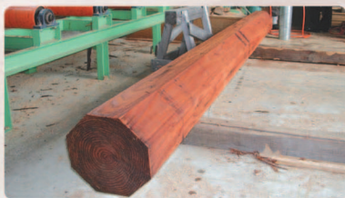
製材工場で柱に加工
